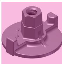
Die in drei verschiedenen Durchmessern erhältliche Tellermutter unterscheidet sich von der Flügelmutter durch eine vergrößerte Aufstandsscheibe. Dadurch ist eine direkte Auflagerung auf den Gurtungen möglich. Diese können mit einem Sechskantschlüssel, einem Gewindestab oder einem Hammer angeschraubt bzw. gelöst werden.
