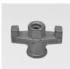
Die Flügelmutter kann bei verschiedenen Unterlagsplatten sowohl für Holz- als auch Stahlgurtungen als Ankermutter verwendet werden. Sie ist so konstruiert, dass sie sowohl mittels Sechskantschlüssel als auch mit einem Gewindestab fixiert bzw. gelöst werden kann. Gegebenenfalls kann eine Klemmwirkung durch Hammerschlag auf die Flügel erzielt bzw. überwunden werden.
