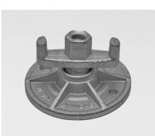
Bei der Kalottenplatte ist die Flügelmutter wie bei der Kombiplatte unverlierbar mit der Platte verbunden. Hier sind allerdings sowohl die Platte als auch die Mutter aus Guss. Die Beweglichkeit der Flügelmutter beträgt bei der quadratischen Platte ca. 15° und bei der runden ca. 5°.
