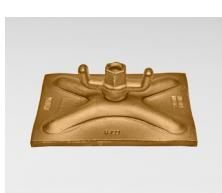
Die Kombiplatte besteht aus einer Unterlagsplatte und einer geschmiedeten Flügelmutter, die zwar beweglich (max. 5°), aber untrennbar miteinander verbunden sind. Die Belastbarkeit für Holz- bzw. Stahlgurtungen entspricht den Werten der Unterlagsplatten.
