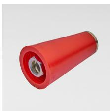
Der Kunststoffkonus mit Stahlkern ist eine Variante zu den Stahlkonen. Sein Anwendungsgebiet und seine Tragfähigkeit sind identisch. Durch die größere Konusneigung und den Kunststoffmantel lässt sich dieser leichter ausschalen. Außerdem kann das zurückbleibende Loch mit dem passenden Betonstopfen wesentlich leichter und besser verklebt werden.
