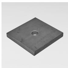
In Verbindung mit einer Flügel- oder Sechskantmutter zur Lastabtragung wird die Vollplatte bei Holz- oder bei Stahlgurtungen verwendet. Die Belastbarkeit richtet sich nach der Aufstandsfläche, der zulässigen Flächenpressung und dem verwendeten Gewindestab.
