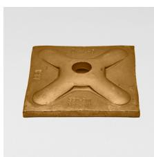
In Verbindung mit einer Flügel- oder Sechskantmutter zur Lastabtragung wird die Unterlagsplatte bei Holz- oder bei Stahlgurtungen verwendet. Die Prägung der Platte erhöht die Eigensteifigkeit. Die Belastbarkeit richtet sich nach der Aufstandsfläche, der zulässigen Flächenpressung und dem verwendeten Gewindestab.
